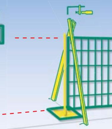
Matte mit Holzlatten und Schraubklemme fixieren. Jetzt eine weitere Matte anklammern und den nächsten Pfosten ausrichten.
