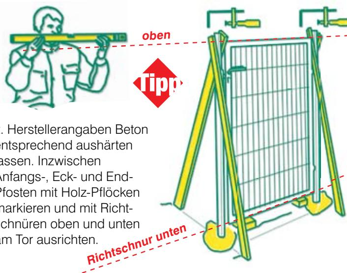
lt. Herstellerangaben Beton entsprechend aushärten lassen. Inzwischen Anfangs-, Eck- und End-Pfosten mit Holz-Pflocken markieren und mit Richtschnüren oben und unten am Tor ausrichten.
