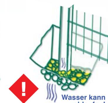
Um Korrosionsschäden zu vermeiden, sollte der Pfosten auf einer Schicht mittelgroßen Kies stehen. Damit ist gewährleistet,
