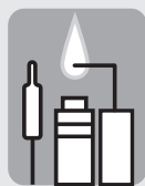
Abb. 4a: Wächterflamme brennt falsch
