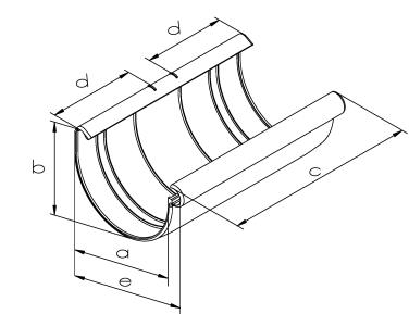
Mit der Rinnenverbindungsschale lassen sich zwei halbrunde Dachrinnen verbinden (Nocke -Nut-System). Bei der Montage ist die Einstekttiefe 'd' zu beachten (Siehe Montage - Anleitung).
