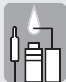
Abb. 4a: Wächterflamme brennt falsch
