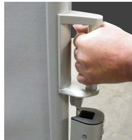
Die sich unten am Handgriff befindene Fixierung in die obere Öffnung des Befestigungsmastes stecken und den Handgriff nach unten drücken. Das Tuch mit dem Ausfallprofil ist jetzt am Befestigungsmast verriegelt.
