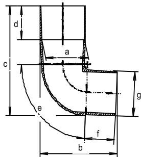
Mit Hilfe des Bogens 87° sind Verbindungen zwischen Fallrohr und Stutzen oder zwischen zwei Fallrohren möglich. Zur Verbindung von zwei Bögen muß ein Fallrohrstück oder der Bogenverbinder zwischengesetzt werden.
