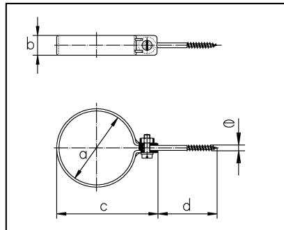
Zur Befestigung der Rohrschelle im Mauerwerk ist ein 8 -mm-Dübel erforderlich. Gewindeschraube, U-Scheibe, Mutter und Ringschraube 6,0 x 70 mm sind im Lieferumfang enthalten. Die Schraube vereinfacht die Montage und ermöglicht eine Los - oder Festschelle .
